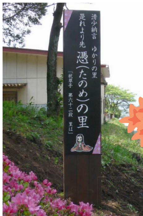
▲憑 (たのめ) の里標識サイン (塩尻市) 表示寸法：H1600mm×W400mm 表示面：住友3Mインクジェット印刷 本体：ハードウッド /H3000mm×W420mm×D60mm
